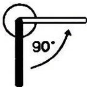
Auf der Innenseite Umstellschlüssel in das Schlüsseloch einführen **bis zum Anschlag**. Umstellschlüssel um 90° entgegen dem Uhrzeigersinn drehen und in dieser Stellung stecken lassen.
